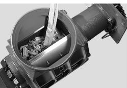
Patentierte Einkammer-Zellradschleuse für höchste Sicherheit gegen Rückbrand
